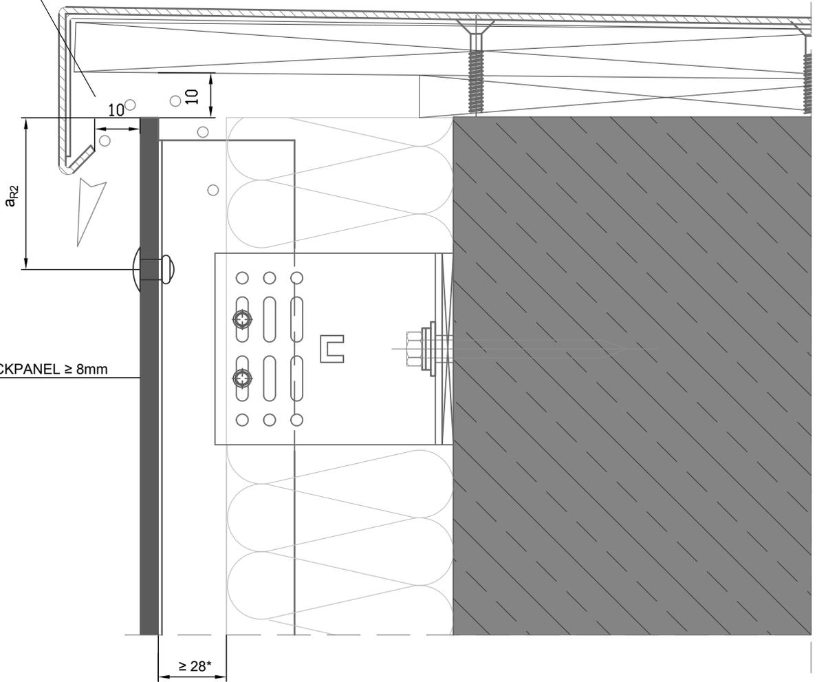
\* EN CASE DE STRUCTURE PORTEUSE EN ALUMINIUM LE GROUPE ROCKPANEL RECOMMANDE UNE LAME D'AIR DE 40 À 100 MM
